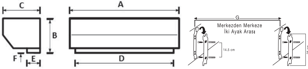
GENEL TİP INOX SERİ ELEKTRİKLİ ISITICILI HAVA PERDELERİ EBAT VE AĞIRLIK TABLOSU
